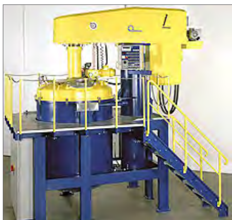
Kompaktowy disolwer zintegrowany z rampą oraz zbiornikiem. Zamontowane celki ważące umożliwiają dokładne dozowanie składników.
