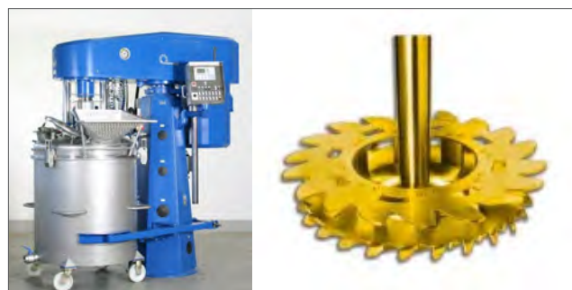
Po lewej: Disolwer przeznaczony do dyspersji proszków w mediach o wysokiej lepkości (pasty PCW, kit, masy uszczelniające, itp.). Urządzenie posiada wbudowaną pompę próżniową pozwalającą wytworzyć w kadzi podciśnienie. Po prawej: Opatentowany dysk dyspergujący z dwoma talerzami - konstrukcja dysku pozwala skrócić czas procesu nawet o 60%.
