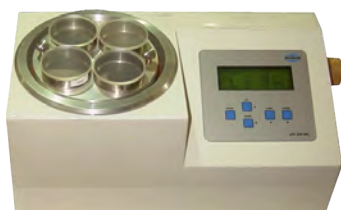
LPS 100MC: przesiewacz może pracować z 4 sitami DN176 (jak na zdjęciu) lub z jednym dużym sitem DN200.
